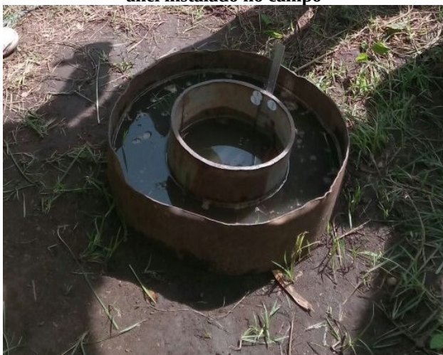
Figura 2. Cilindro infiltrômetro ou infiltrômetro de anel instalado no campo
